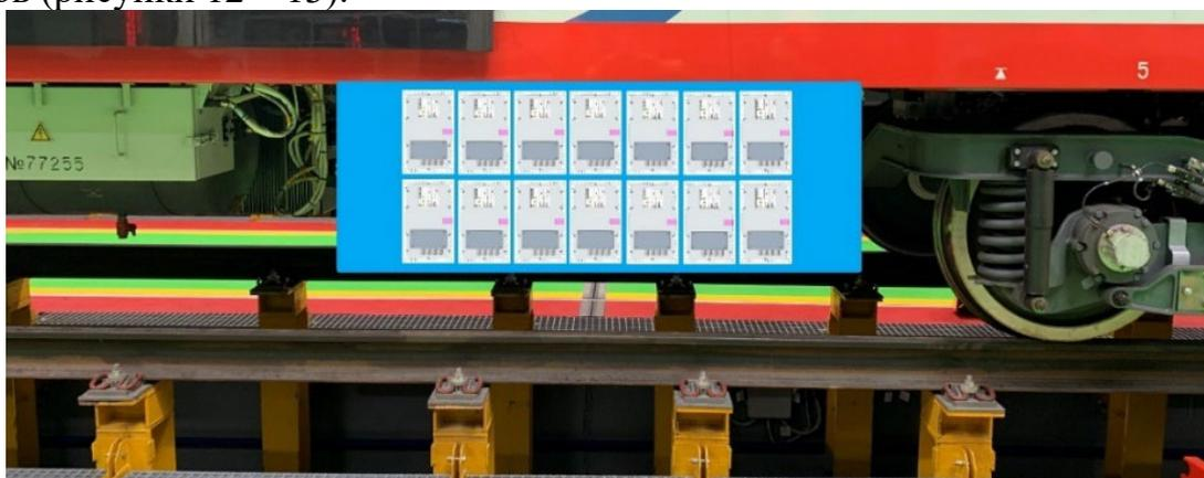
Рисунок 12 – Графический монтаж расположения БНЭ типа МО-150В50Ф-0-3 с соблюдением габаритных размеров
